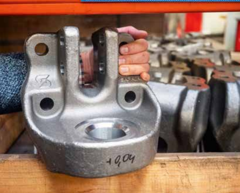
Korpus zaczepu po obróbce CNC z wykonanymi otworami montażowymi i ukształtowanymi szynami prowadzącymi, z oznaczonymi korektami wymiarów do montażu.
